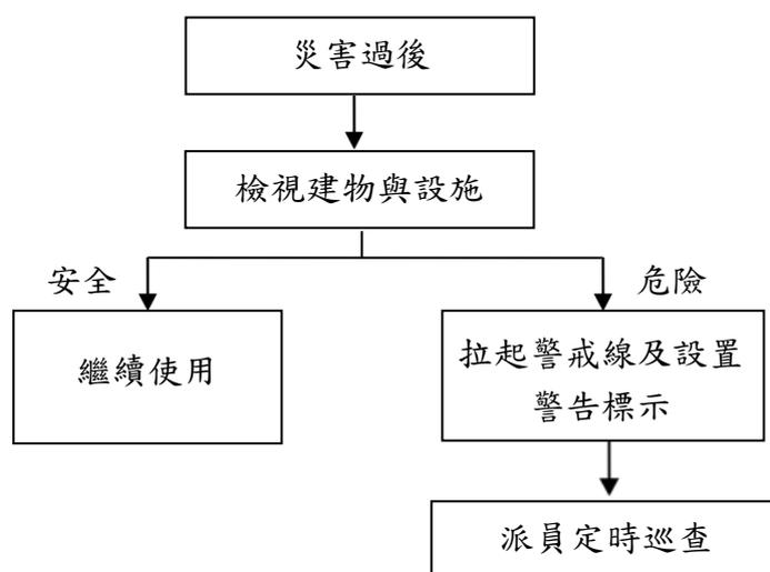
圖 5-4 災後毀損建物警示流程圖
